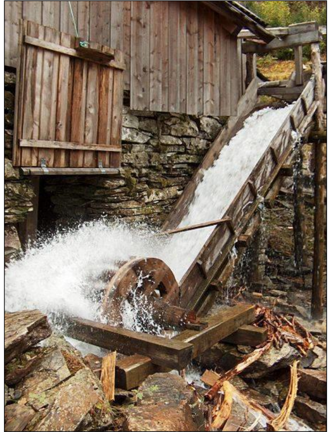
Eksempel på en oppgangssaga med et underfallshjul. Vannet ledes fra toppen via en renne ned mot vannhjulet som drives rundt. Foto: Svein Harkestad
